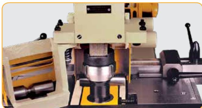
Attrezzatura per punzonatura fino a Ø 36 x 8 mm di spessore
