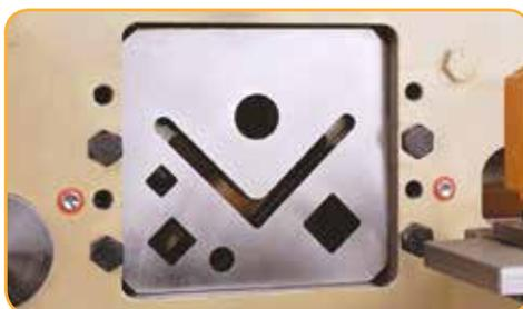
Vasta gamma di aperture per taglio  $\emptyset$  e  $\nabla$  senza deformazione
