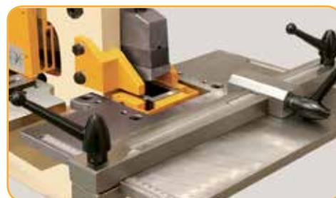
Attrezzatura per scantonatura rettangolare con tavola e arresti millimetrati
